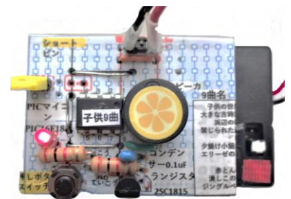
図 2-1 PIC マイコン によるハミングバード
